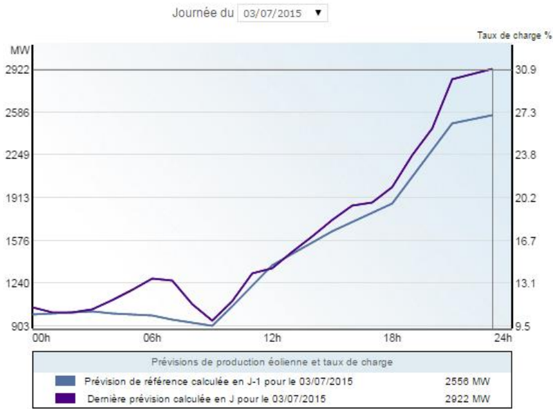
Figure 3. Extrait du site RTE - estimation de la production éolienne le 3 juillet 2015 en France
